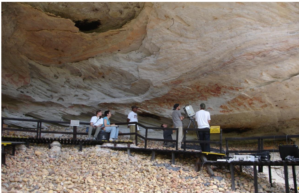
Figura 12: Escaneamento da Toca da Entrada do Pajaú através do scanner Konica Minolta Vivid910 . Fonte: Arquivo imagético da Fumdham, ano 2006.
